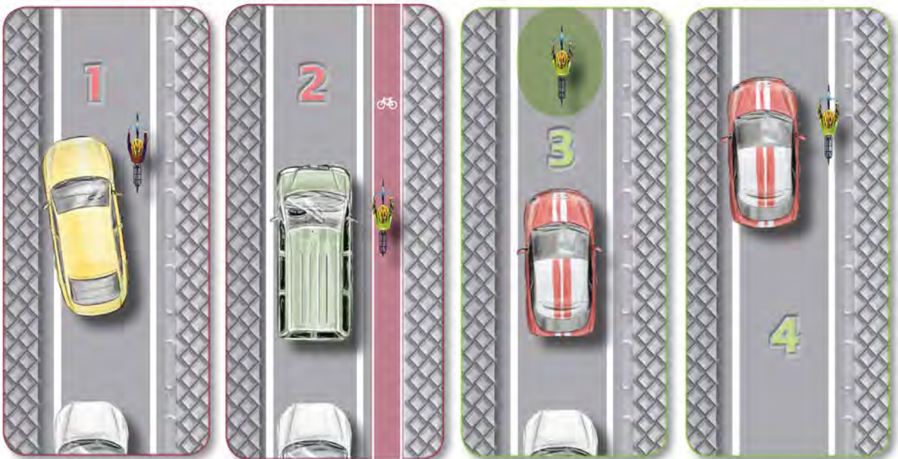
1 y 2. Adelantamiento sin distancia lateral de seguridad
